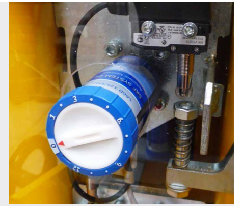
AUTOMATISCHES SCHMIERSYSTEM Automatic lubrication system
